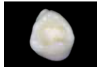
Harvard BioCal®-Line ausgehärtet nach 40 Sek. Lichthärtung
